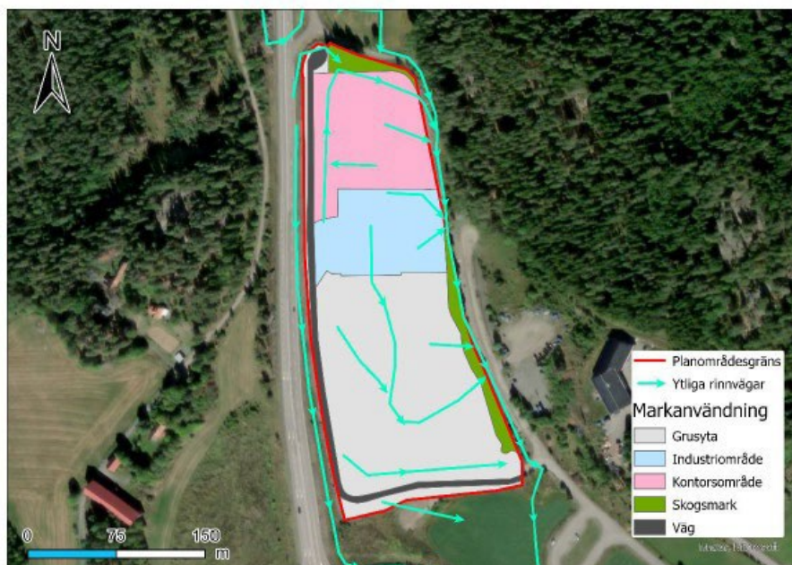
Figur 4: Bilden illustrerar de ytliga rinnvägarnas deras riktning (gröna pilar) inom och i angränsning till planområdet. Illustration framtagen av Ramboll AB, 2025.
