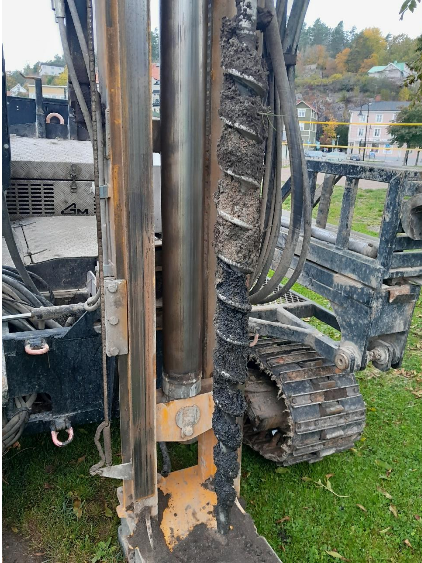
Figur 10. Provpunkten 24SM15 (0-1,0 m u my), här syns svart blöt fyllningsjord från 0,5 m. Senare analys visade att föroreningshalter trots det var under riktvärdet för KM.
