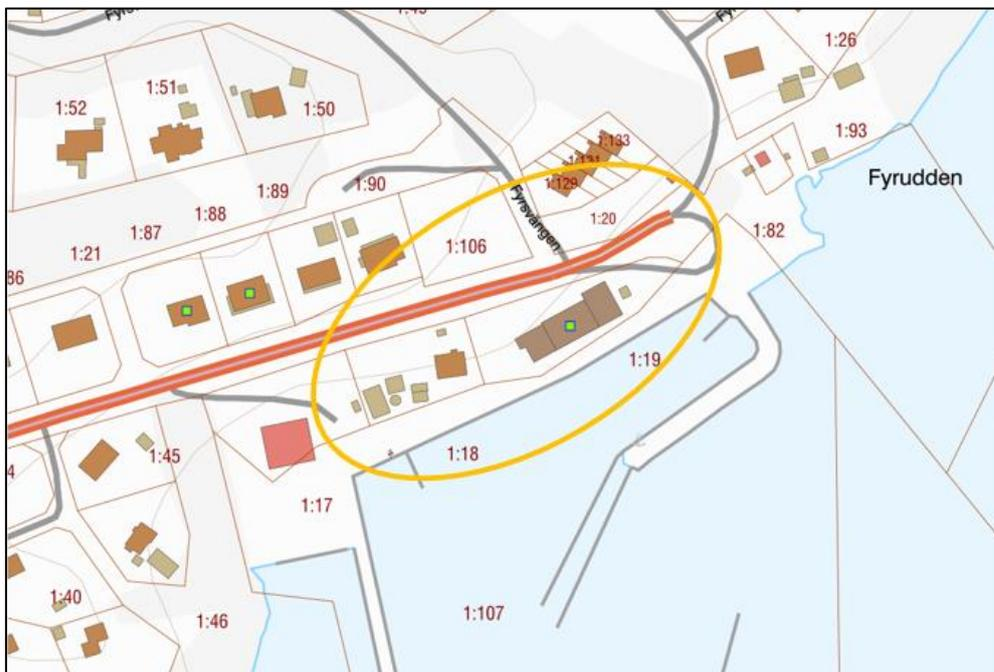
Figur 6. Utdrag ur SGU:s brunnregister med energibrunnarna markerade med gröna fyrkanter. Planområdet är ungefärligen markerat med orange ellips (SGU, 2023).
