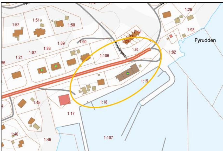
Figur 5. Utdrag ur SGU:s brunnregister med energibrunnarna markerade med gröna fyrkanter. Planområdet är ungefärligen markerat med orange ellips (SGU, 2023).
