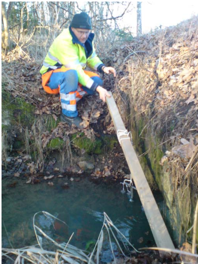
Bild 2: Utsättning av PSO-2 i dagvattendiket uppströms PCB-deponin.
