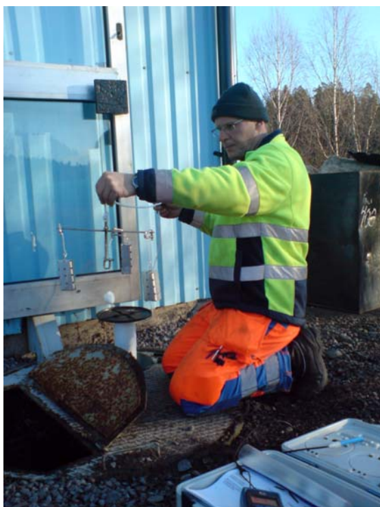
Bild 3: Utsättning av PSO-2 samt PSM-1-DGT i brunnen utanför S1.
