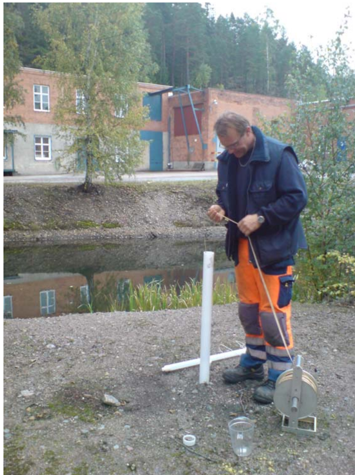
Figur 2: Omsättning av grundvattenrör 6 (P6GV) i maj 2008. .
