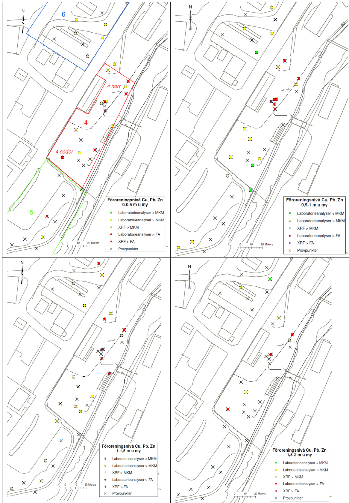
Figur 4 Provtagningspunkter med halter av Pb, Cu och Zn över respektive riktvärde per nivå 0-2 m u my.
