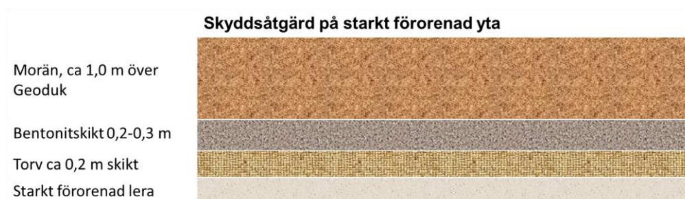
Figur 10 Principskiss för skyddsåtgärd på restförorening med klorerade alifater.
