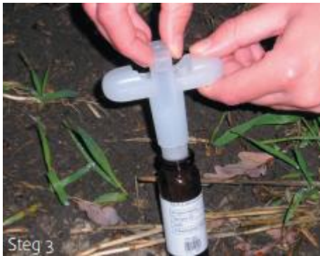
Figur 5 Provtagning av jord med TerraCore-provtagare där uppsamlad jord trycks ned i metanolvialer
