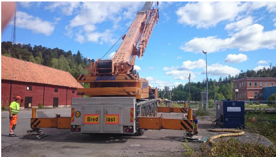
Figur 1 Mobil lyftkran för sondering med balk
