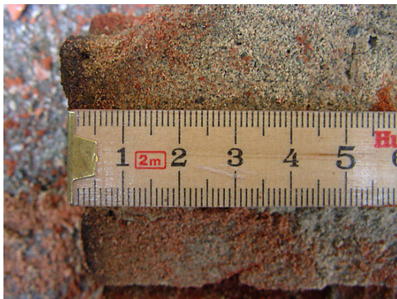
Bild 11. E103tg - oljan ser inte ut att gå speciellt djupt 2008-09-26.
