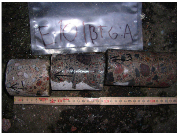
Bild 9. E101btg - omgjutet två gånger 2008-09-25.
