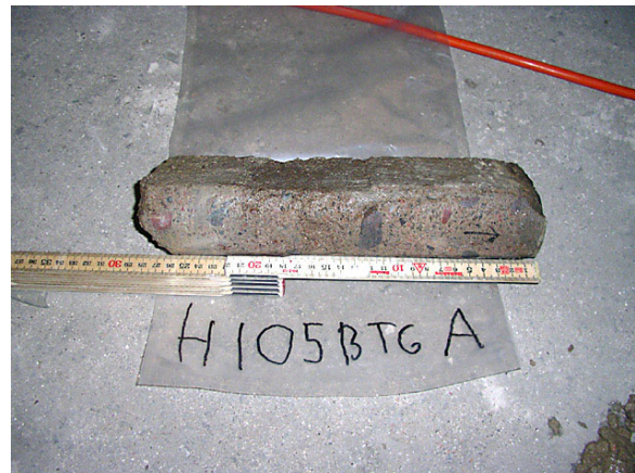
Bild 16. H105btg vid fundamenten är golvet tjockare, 2008-10-28.
