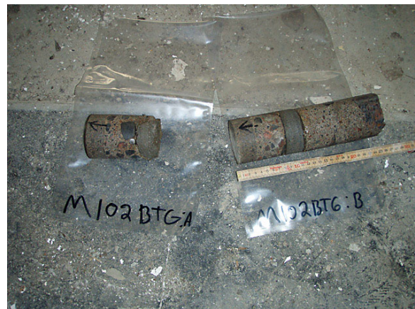
Bild 10. M102btg, golv omgjutet 1 eller 2 gånger, 2008-09-24.
