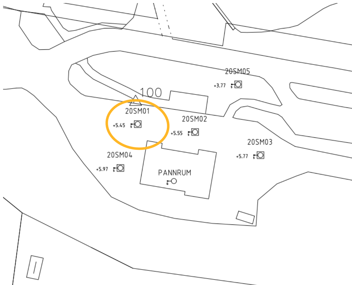
Figur 4. Uppskattad omfattning ytlig kvicksilverförorening i yta.
